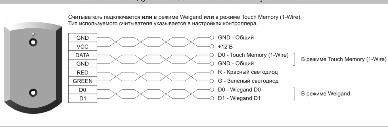
Рис. 10. Рекомендуемое подключение Proximity считывателей
